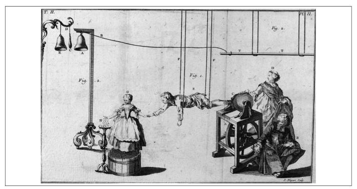
Figure 4. The flying boy experiment. On the right, a globe electrical machine: the lady electrifies the glass as the gentleman turns the wheel connected to the globe. From William Watson (1748) *Expériences et observations pour servir à l'explication de la nature et des propriétés de l'électricité*, Paris. Courtesy of the Institute and Museum of the History of Science, Florence.
